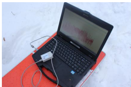
Фото 1 Цифровая лаборатория «Экология», включающая датчик звука с функцией интегрирования, подключённый к нетбуку.
